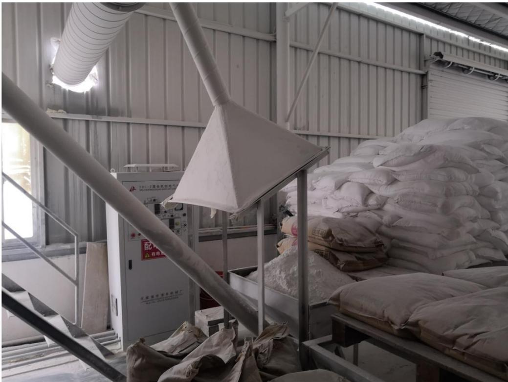
破碎、磨粉工序集气罩
